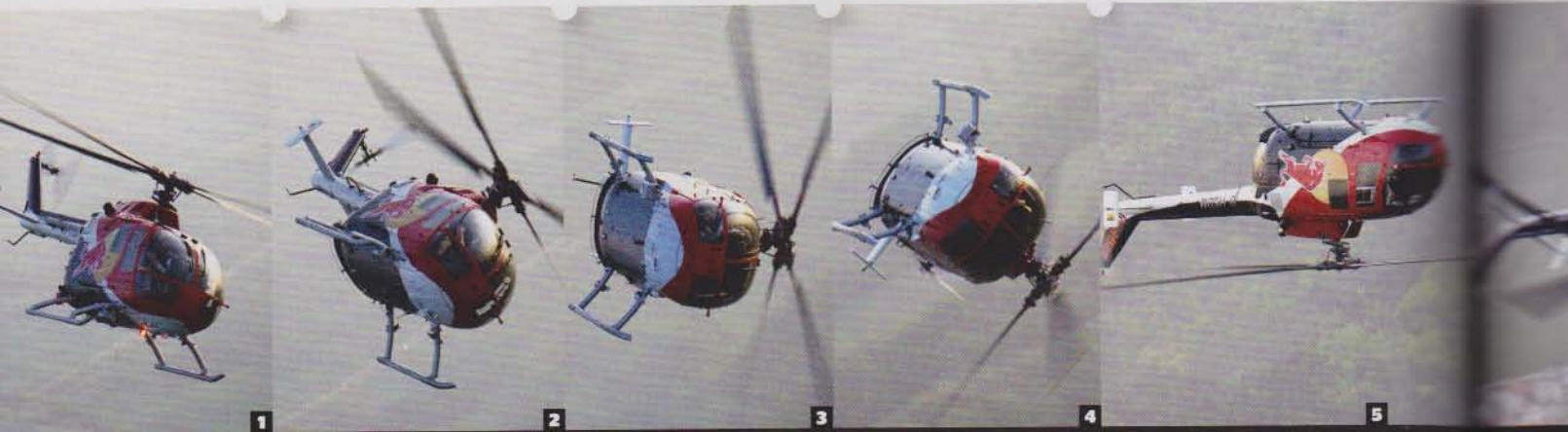
Im Hubschrauber funktioniert der Rückenflug nur für Momente: Pilot Wilke fliegt an, kippt die Maschine auf den Rücken – und dreht gleich weiter.
